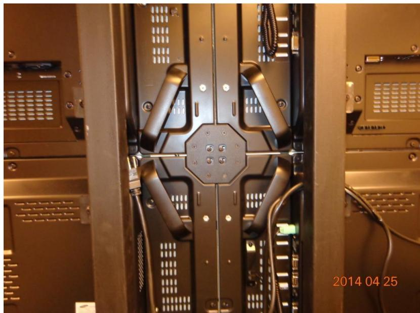
**Figura 6 - Dispositivos metálicos de travamento central**
