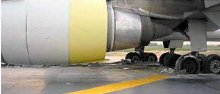
2 - A relação pneu/EMAS fornece cargas de resistência para a desaceleração.
