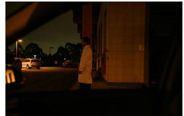
Visão do condutor - Distância entre a lateral direita do veículo e o pedestre é de 5 m.
