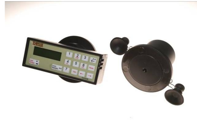
Até a data da conclusão deste relatório o medidor de transmitância não havia sido homologado pelo INMETRO. Entretanto, realizado teste em vidro com transmitância conhecida o aparelho apresentou resultado dentro da escala de erro relativo máximo:  $\pm 3\%$ .
