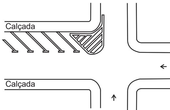
MARCA DELIMITADORA PARA PARADA DE ÔNIBUS EM FAIXA DE ESTACIONAMENTO
