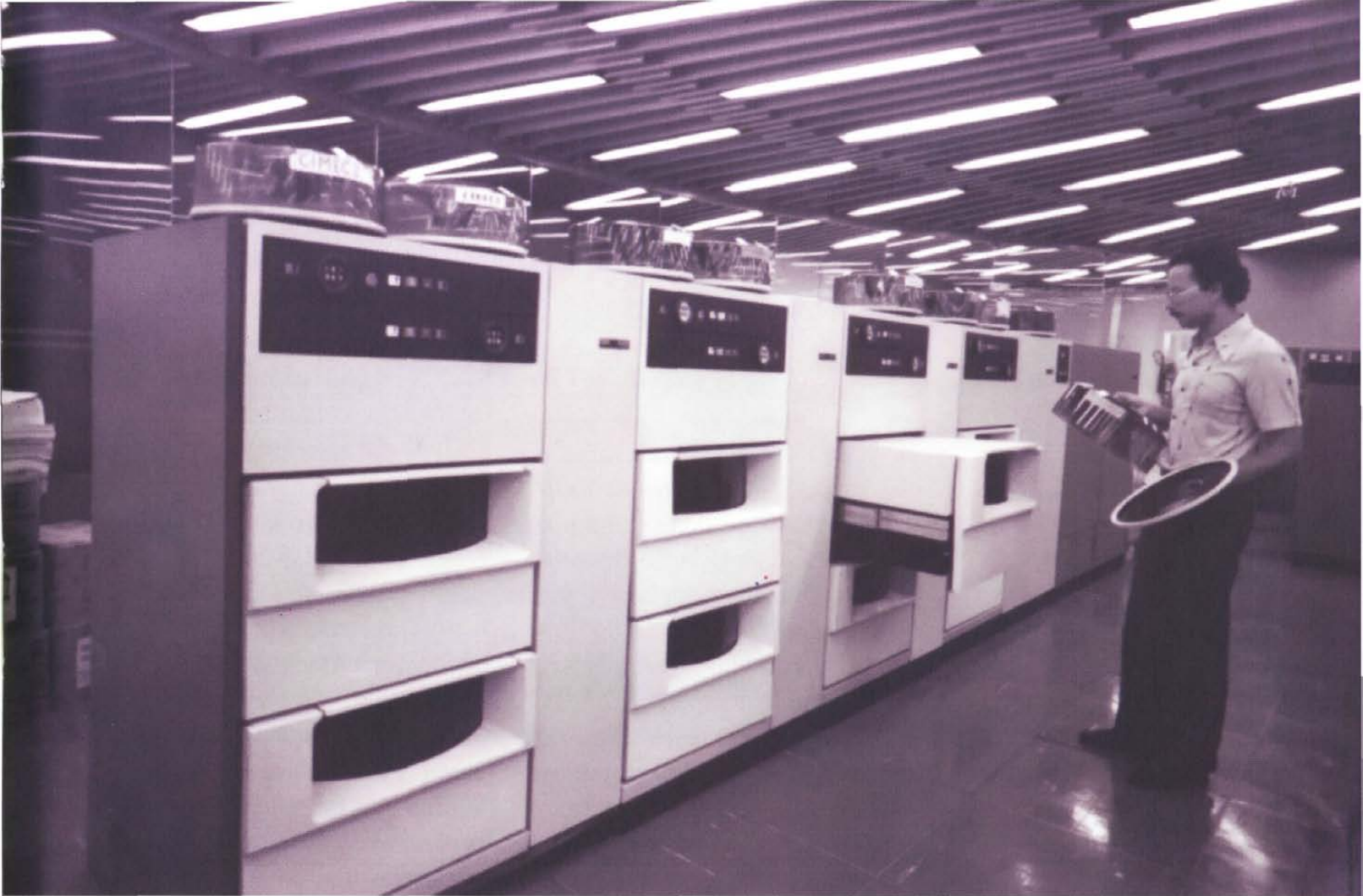
O armazenamento das bases de dados era feito em discos magnéticos removíveis, acoplados como periféricos ao computador central
